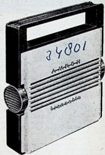
Afb. 2 - HET KASTJE VAN DE TRAN- SETTE bestaat uit drie delen: een zwart frame, waarop twee lichtgekleurde kappen worden geschroefd. De bevestigingsboutjes hiervan zijn onder de knoppen verborgen. De schuifconstructie van de knoppen maakt deze zeer makkelijk afneembaar, waardoor batterijverwisseling geen probleem is.
